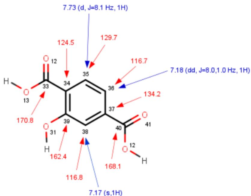
**Slika 20.**  $^1\text{H}$  (600 MHz, plavo) i  $^{13}\text{C}$  (151 MHz, crveno) NMR kemijski pomaci za strukturu spoja **4** u  $\text{DMSO-d}_6$  pri 25 °C, jedinica ppm nije navedena zbog jasnoće prikaza (Izvor: MarvinSketch)
