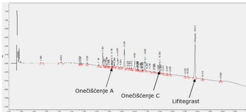
**Slika 15.** Kromatogram onečišćenja uzorka izlaganog oksidaciji s  $H_2O_2$  ( $T_{30}$  -  $50^\circ C/75\%RV$ )
