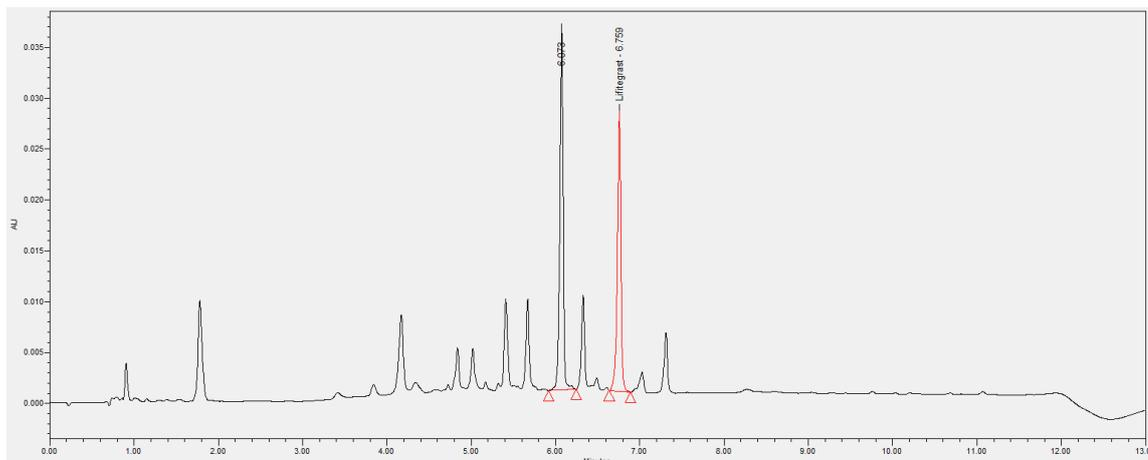
**Slika 18.** Kromatogram sadržaja uzorka izlaganog oksidaciji s AIBN-om ( $T_{15} - 50^{\circ}\text{C}/75\%RV$ )
