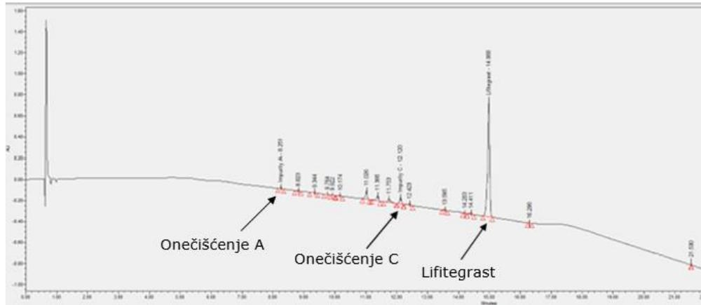
**Slika 9.** Kromatogram onečišćenja uzorka izlaganog oksidaciji s  $H_2O_2$  pri temp.  $50^\circ C/75\%RV$
