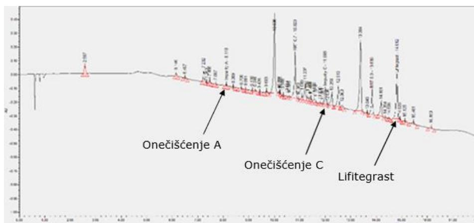
**Slika 17.** Kromatogram onečišćenja uzorka izlaganog oksidaciji s AIBN-om ( $T_{30} - 50^{\circ}\text{C}/75\%RV$ )
