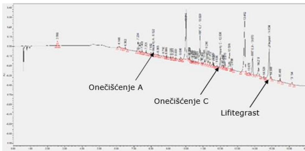
**Slika 19.** Kromatogram onečišćenja uzorka izlaganog oksidaciji s AIBN-om ( $T_{15} - 50^{\circ}\text{C}/75\%RV$ )
