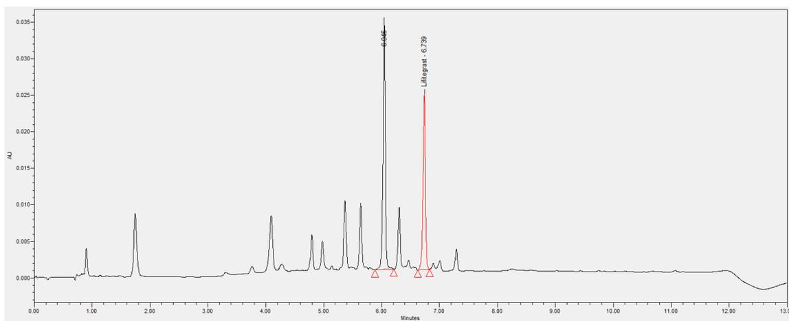
**Slika 16.** Kromatogram sadržaja uzorka izlaganog oksidaciji s AIBN-om ( $T_{30}$  -  $50^\circ C/75\%RV$ )
