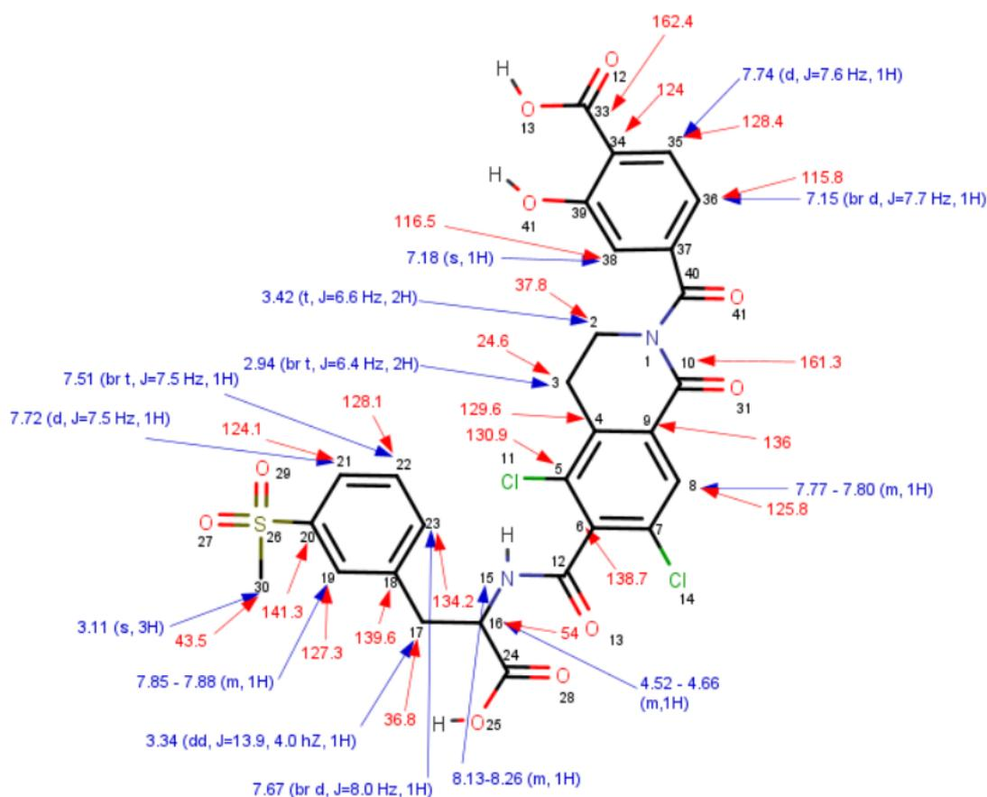
**Slika 22:**  $^1\text{H}$  (600 MHz, plavo) i  $^{13}\text{C}$  (151 MHz, crveno) NMR kemijski pomaci za strukturu spoja **5** u  $\text{DMSO-d}_6$  pri  $25^\circ\text{C}$ , jedinica ppm nije navedena zbog jasnoće prikaza (Izvor: MarvinSketch)
