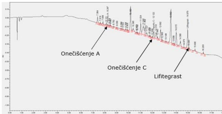
**Slika 11.** Kromatogram onečišćenja uzorka izlaganog oksidaciji s AIBN-om pri temp. 50°C/75%RV
