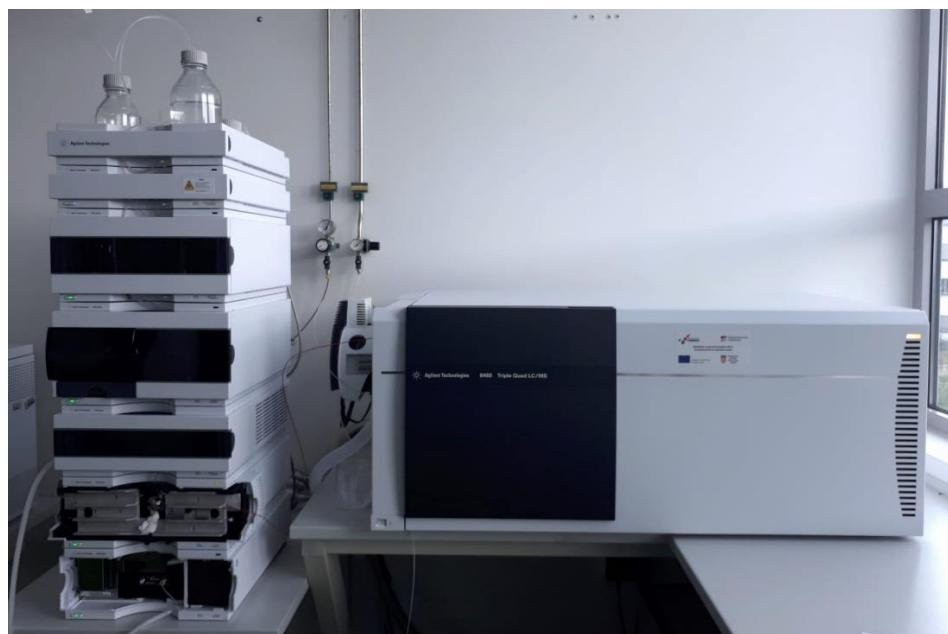
**Slika 9** HPLC-MS uređaj sa trostrukim kvadrupolnim analizatorom mase.
