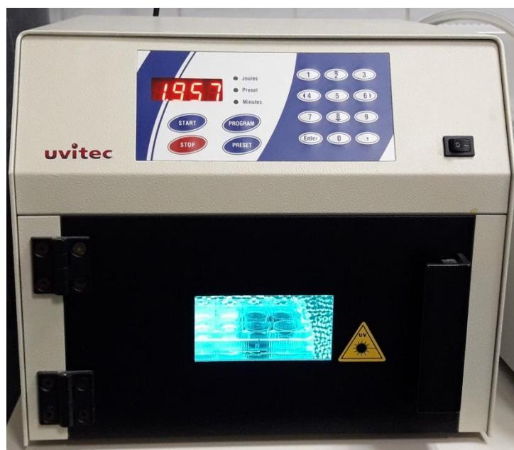
**Slika 6.** Suspenzija limfocita i puna krv izloženi UVB zračenju od  $2 \text{ kJ/m}^2$  pomoću uređaja Uvitec Crosslinker CL-E508M (Cambridge, Velika Britanija).
