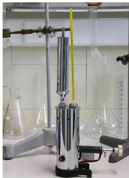
Slika 9 Električni ebulioskop po Salleronu korišten za određivanje stvarne volumne alkoholne jakosti
