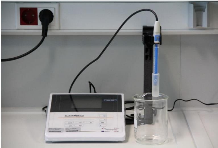
Slika 8 pH metar (SI Analytics, Lab 860, Njemačka) upotrjebljen za određivanje pH vrijednosti vina
