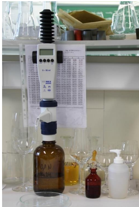
Slika 10 Automatska bireta na otopini 0,01 M NaOH te bromtimol korišteni za određivanje ukupne kiselosti u vinu
