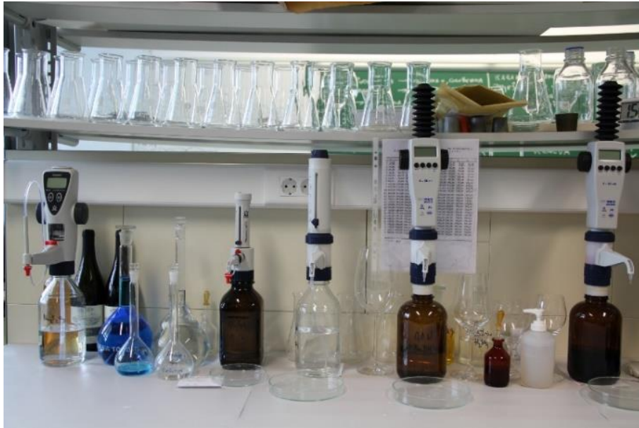
Slika 11 Automatske birete, otopine i reagensi korišteni pri određivanju vrijednosti parametara titracijom
