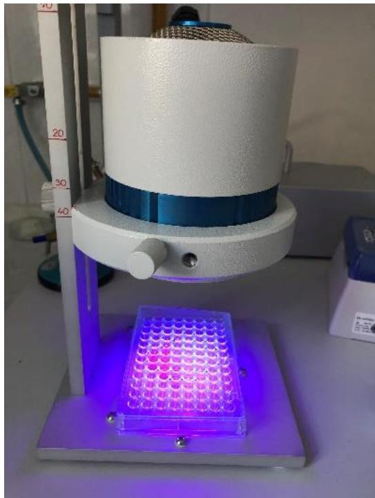
Slika 8. Prikaz osvjetljavanja mikrotitarske pločice LED lampom valne duljine 394 nm i intenziteta  $40 \text{ mW/cm}^2$ .
