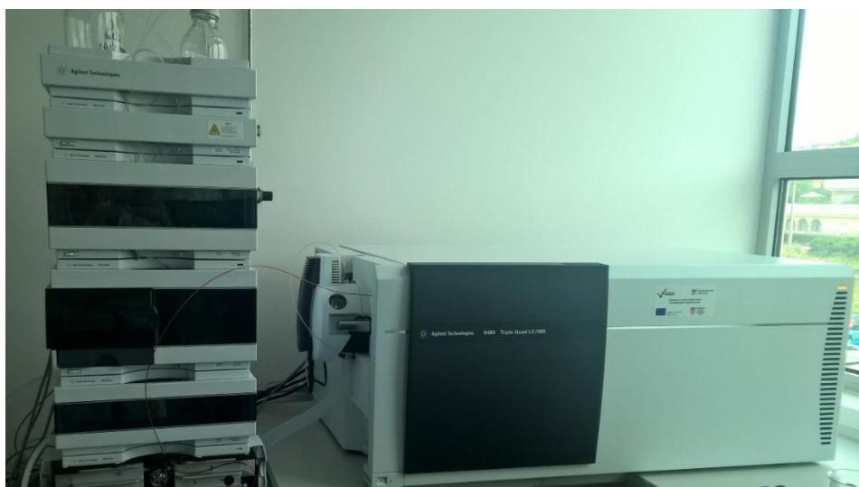
**Slika 3. Visokoprotečni tekućinski kromatograf (HPLC) spregnut s masenim spektrometrom te analizatorom trostrukim kvadropolom (MS-QQQ) prikazan je na slici. Uređaj se nalazi u prostorijama Odjela za biotehnologiju u Rijeci.**
