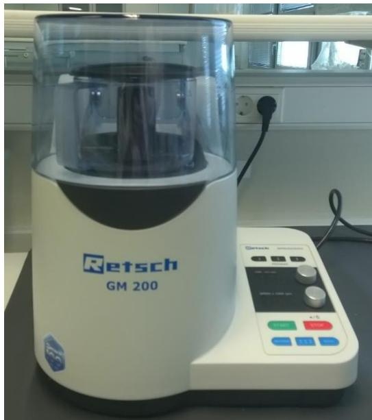
**Slika 2. Mlin za usitnjavanje Retsch GM 200**
