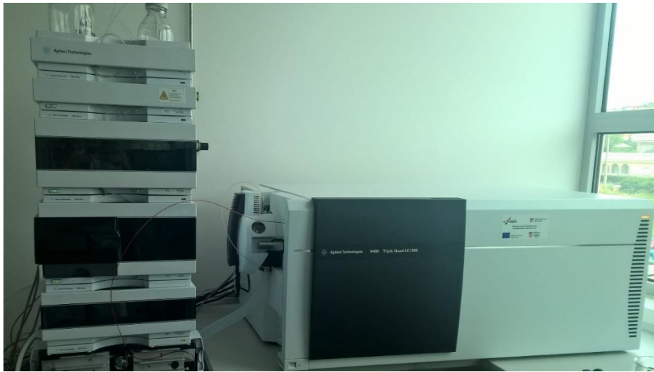
Slika 3. Visokoprotlačni tekućinski kromatograf (HPLC) spregnut s masenim spektrometrom te analizatorom trostrukim kvadropolom (MS-MS) prikazan je na slici. Uređaj se nalazi u prostorijama Odjela za biotehnologiju u Rijeci.
