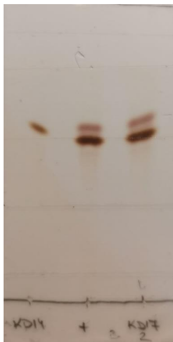
Slika 22. TLC kromatogram nukleofilne acilne supstitucije.
