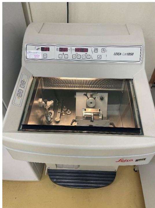
Slika 3. Kriostat Leica CM1850 (Wetzlar, Njemačka) koji se koristio pri rezanju moždanog tkiva.
