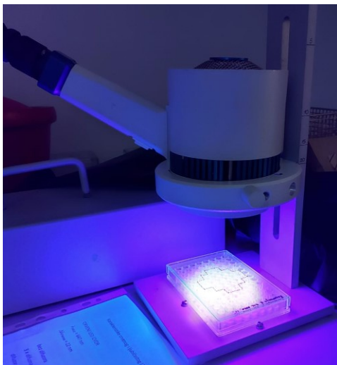
Slika 14. Prikaz LED lampe ( \lambda=395 nm i intenzitet 20 mW/cm 2 ) koja je korištena kao izvor svjetlosti za provođenje eksperimenata u ovom radu.
