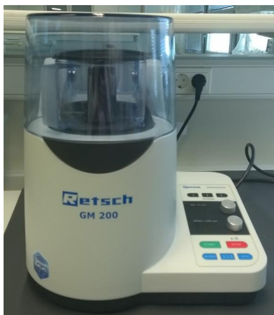
Slika 2. Mlin za usitnjavanje Retsch GM 200
