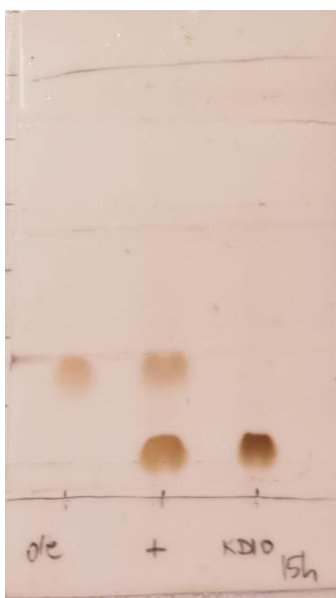
Slika 17. TLC kromatogram aktivacije oleinske kiseline NHS-om.
