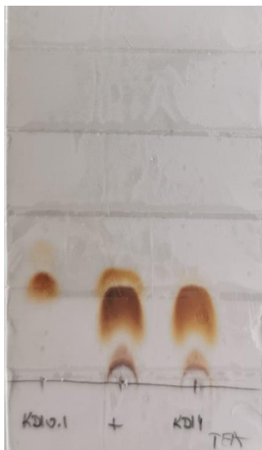
Slika 18. TLC kromatogram epoksidacije sukcinimidil oleata.
