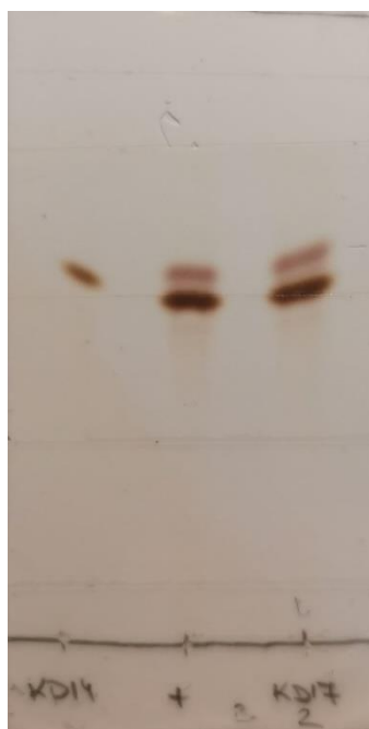
Slika 22. TLC kromatogram nukleofilne acilne supstitucije.
