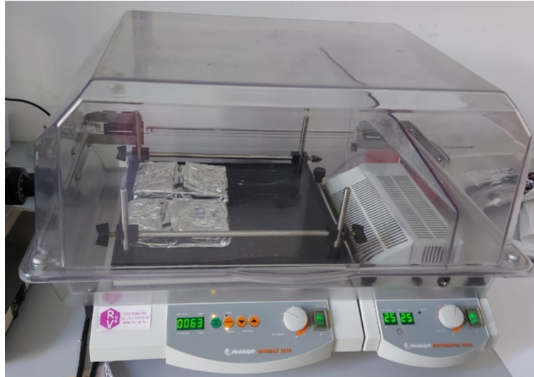
Slika 13. Prikaz tresilice (Heidolph UNIMAX 1010, Njemačka) u kojoj su pripremljeni uzorci inkubirani u mraku, pri sobnoj temperaturi, kroz 30 minuta
