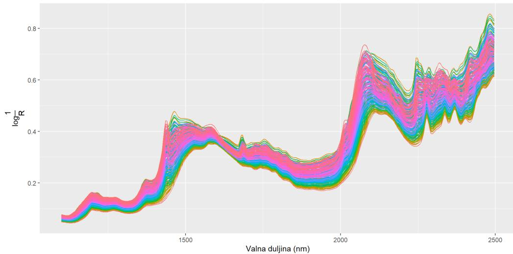
Slika 3.4 Eksperimentalni NIR spektri trokomponentnih smjesa saharoze, glukoze i fruktoze, snimljeni pomoću NIR spektrometra (FOSS NIRSystems 6500) u načinu mjerjenja difuzne refleksije.
