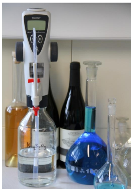
Slika 13 Automatska bireta spojena na otopinu Na_2S_2O_3 te Fehling I i II korišteni pri određivanju vrijednosti reducirajućih šećera titracijom
