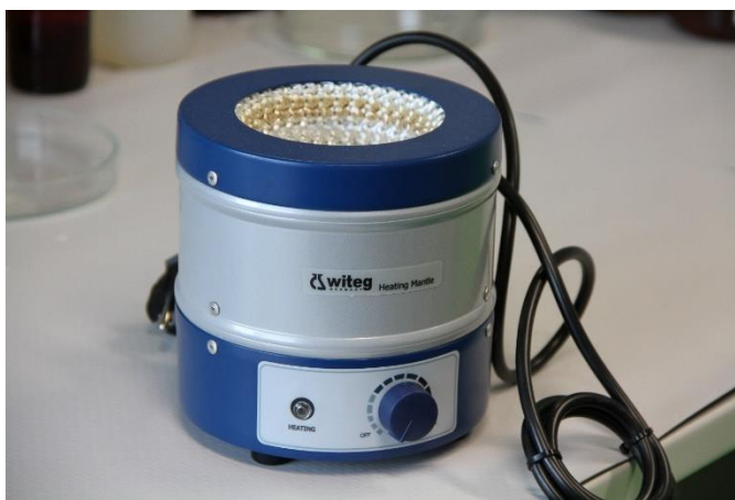
Slika 12 Grijač korišten u postupku određivanja vrijednosti reducirajućih šećera
