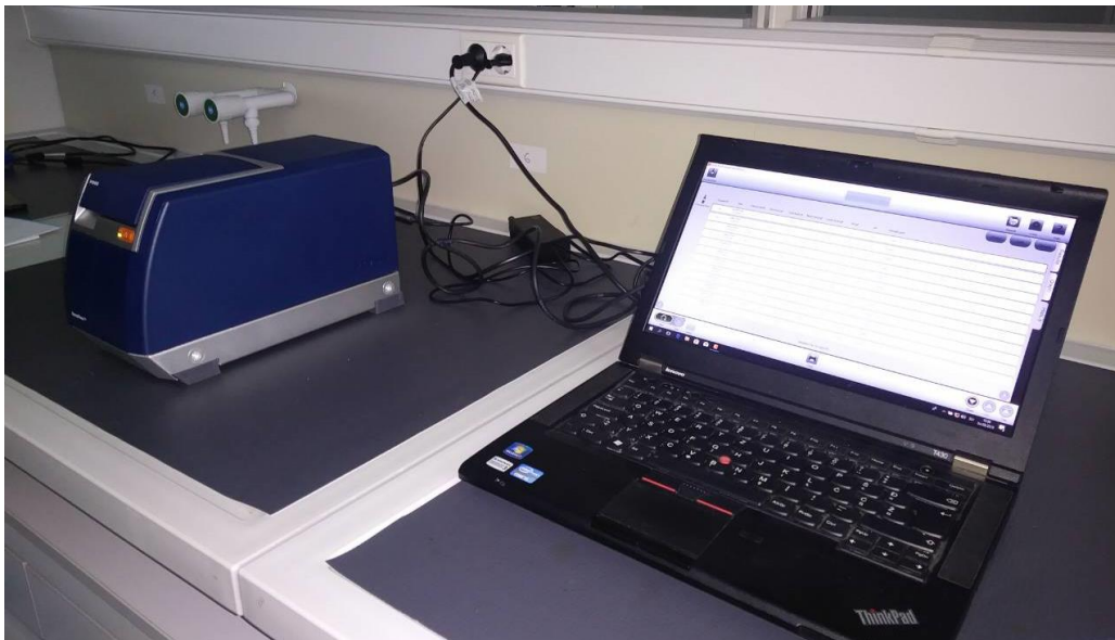
Slika 14 OenoFoss FTIR uređaj za određivanje parametara kakvoće vina na temelju spektroskopije
