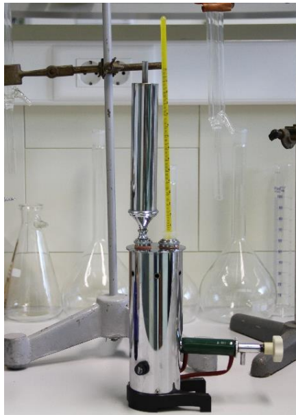
Slika 9 Električni ebulioskop po Salleronu korišten za određivanje stvarne volumne alkoholne jakosti
