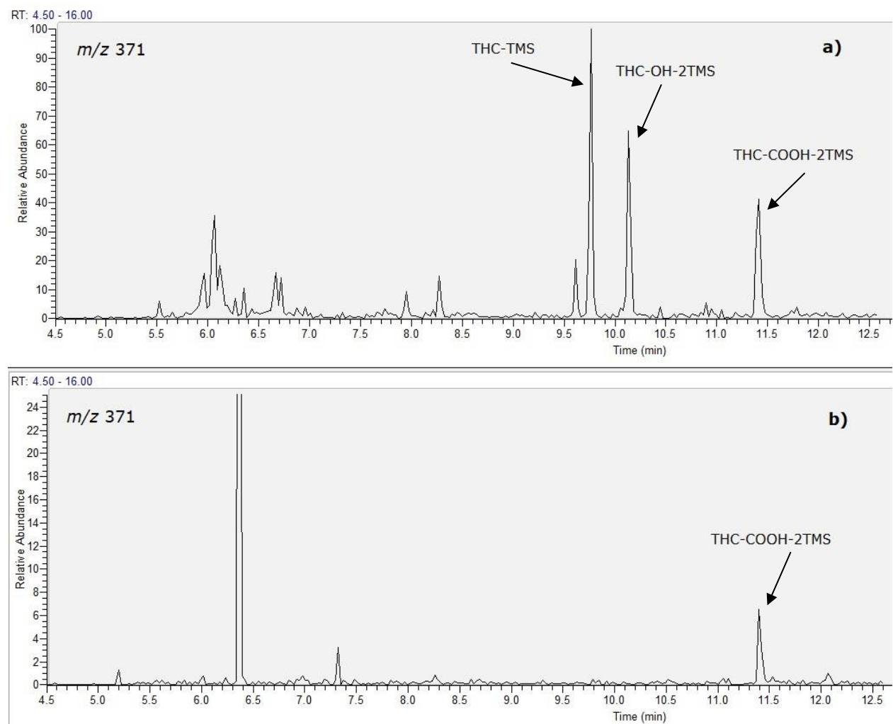
*Slika 5. Ionski kromatogrami uzorka urina štakora iz: a) kontrolne grupe koji sadrži 20 µg/L THC, THC-OH i THC-COOH i b) grupe THC s masenom koncentracijom THC-COOH od 15,7 µg/L. THC i THC-OH nisu detektirani. Za kvantifikaciju svih triju analita korišten je ion m/z 371.*
