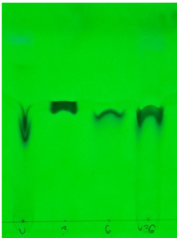
Slika 3. Razvijena TLC pločica vizualizirana pod UV svjetlom. S lijeva na desno testirane supstance su uzorak P. hoppeana (U), standard 3,5-CQA (3), standard CGA (6), kombinacija uzorka i oba standarda (U36).
